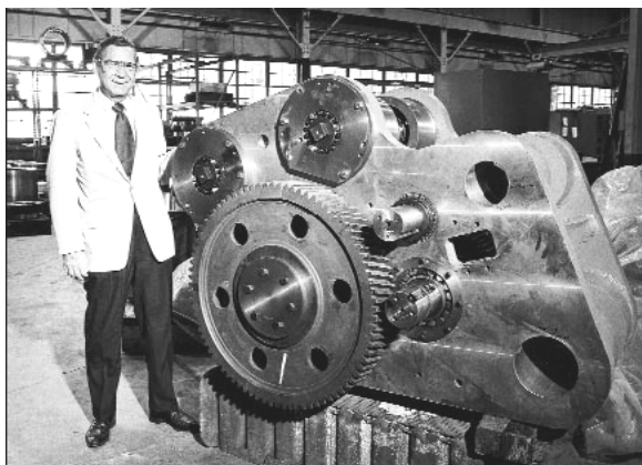
Prasa do zgrzewania - zamocowanie dźwigni za pomocą pierścieni RfN 7012
